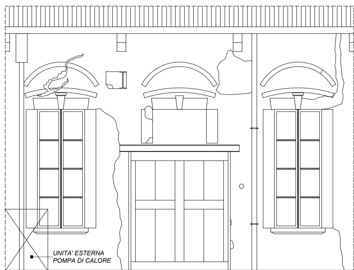
PARTICOLARE INGRESSO LATO SUD SCALA 1:50 - STATO ATTUALE
