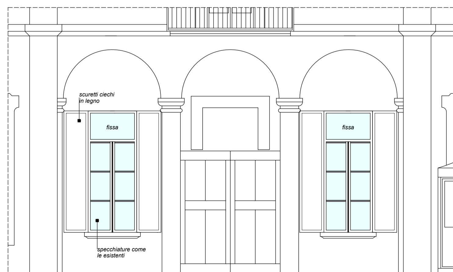
PARTICOLARE INGRESSO ANDITO NORD SCALA 1:50 - STATO FINALE
